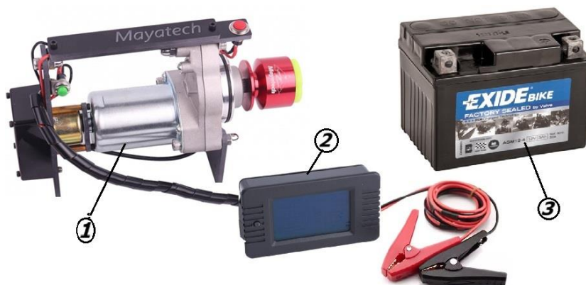
Рисунок 1 – Конструктивна схема для визначення потужності механічних втрат методом прокручування колінчастого валу: 1- стартер; 2-ватметр PZEM-015; 3-АКБ
