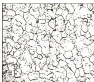
Рисунок 3 - Мікроструктура сталі 08кп після відпалу при 720 °С із видержкою: а –15 с ; б – 15 с; х 500
