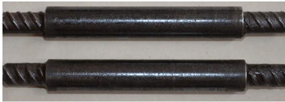
Рис. 9. Склеєне з'єднання арматурні стрижні-гільза в зборі
