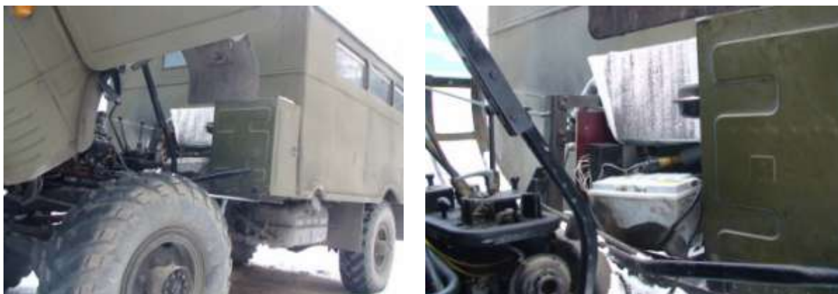
Рисунок 1 – Транспортний засіб ГАЗ-66-11 під час випробувань системи передпускового і післяпускового прогріву двигуна та кабіни
