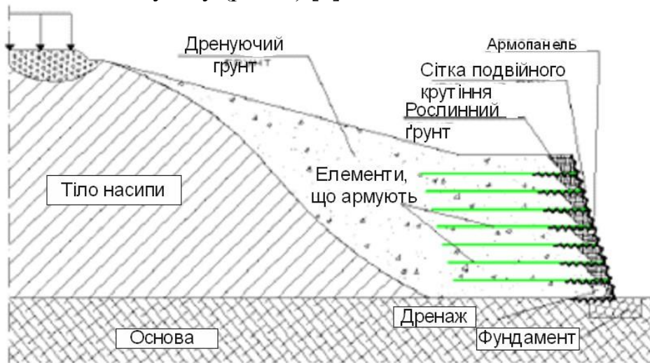
Рисунок 3 – Схема поперечного профілю насипу, посиленого армоґрунтовою стіною системи Зелений Террамеш
