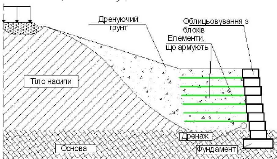
Рисунок 6 – Схема поперечного профілю насипу, посиленого армоґрунтовою стіною з облицьовуванням з блоків
