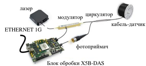
Рис. 11. Оптична система локалізації акустичних сигналів від місця КЗ на місцевості
