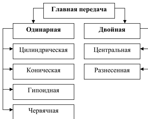
Рис. 1.13. Типы главных передач
