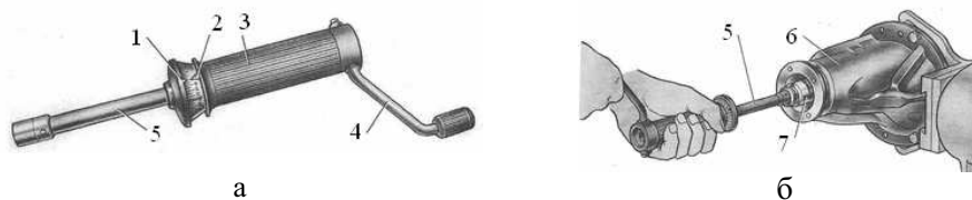
Рис. 4.26. Динамометр (а) и определение предварительного натяга подшипников (б):
