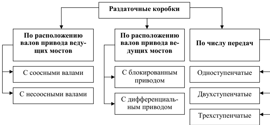
Рис. 1.6. Типы раздаточных коробок, классифицированных по различным признакам
