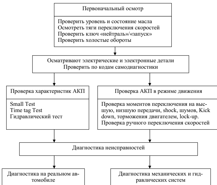
Рис. 4.27. Алгоритм поиска неисправностей АКП
