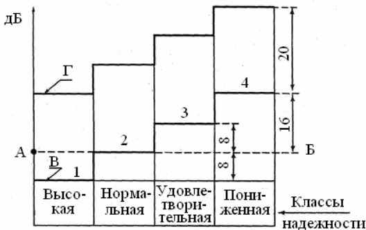
Рис. 4.71. Классификация надежности ресурсных элементов проектируемых машин по классам вибрации
