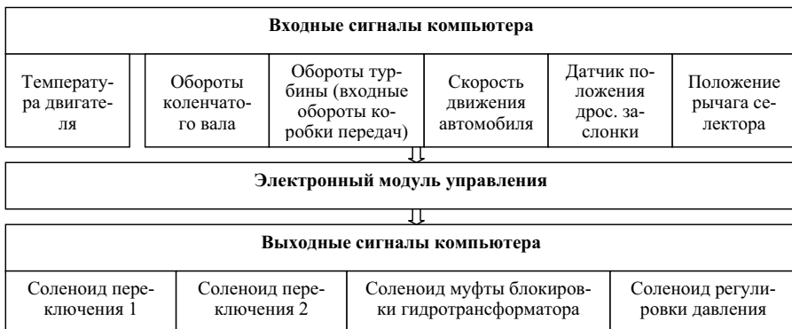
Рис. 4.69. Упрощенная блок-схема работы электроники
