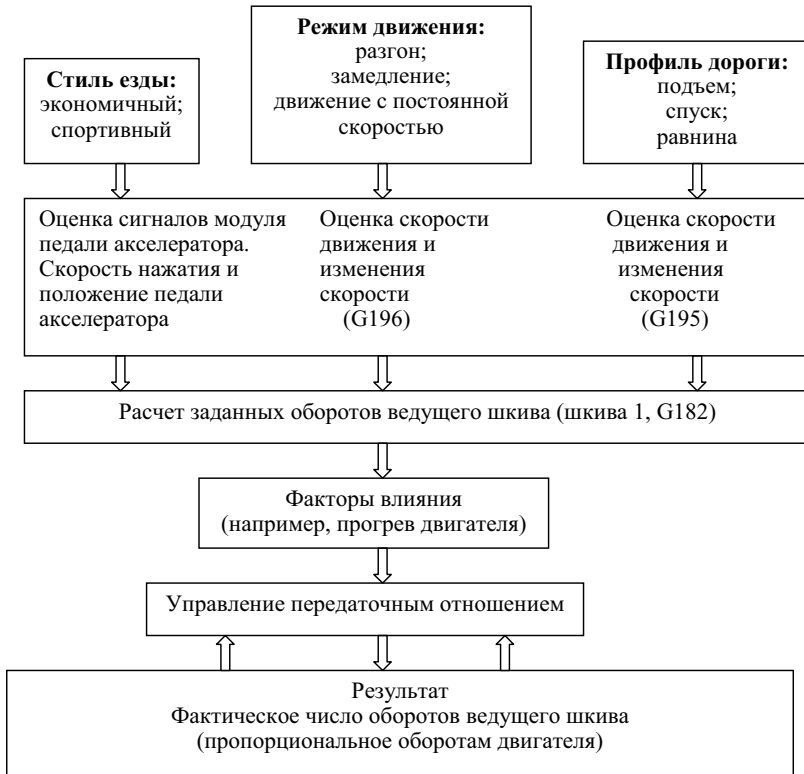
Рис. 1.16. Программа регулирования заданного числа оборотов
