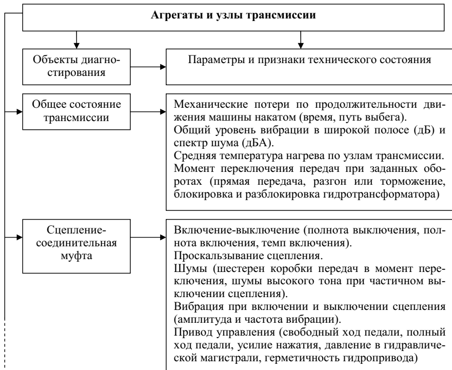
Рис. 3.1. Диагностические параметры отдельных узлов трансмиссии
