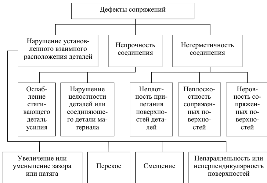
Рис. 2.3. Схема классификации дефектов сопряжений
