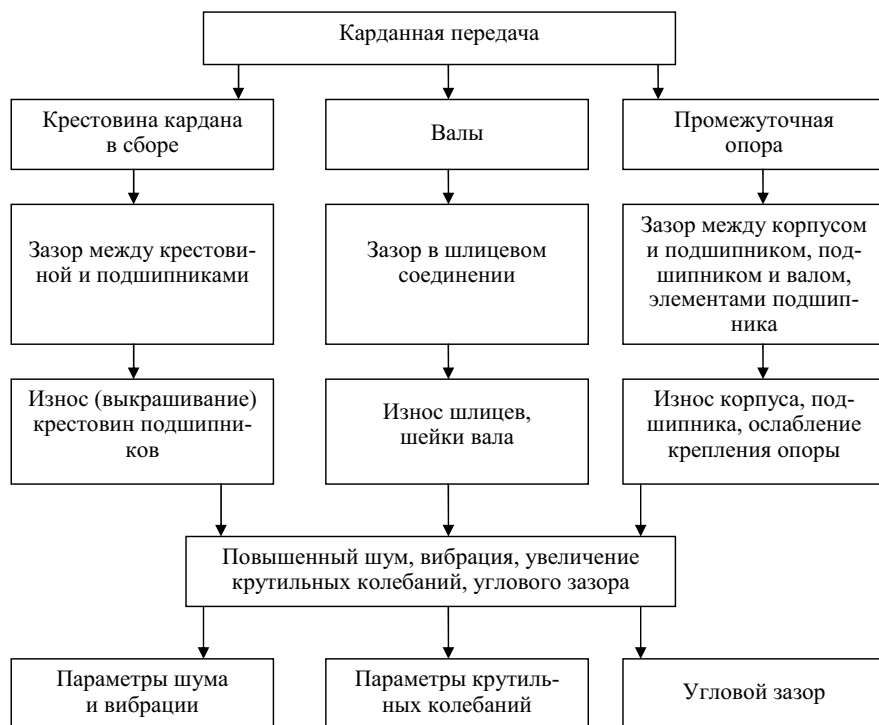
Рис. 3.5. Блок-схема структурно-следственных связей элементов карданной передачи
