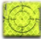
Рисунок 1 – Фотографія марки, яка використовувалася в геодезичних роботах при капітальному ремонті автомобільної дороги Н-07 Київ – Суми – Юнаківка
