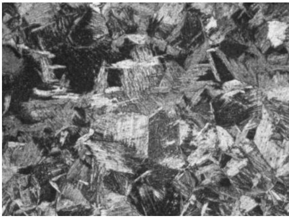
Рисунок 3б - Мікроструктура сплаву Grade 9 після пресування і охолодження на повітрі (середина стінки)
