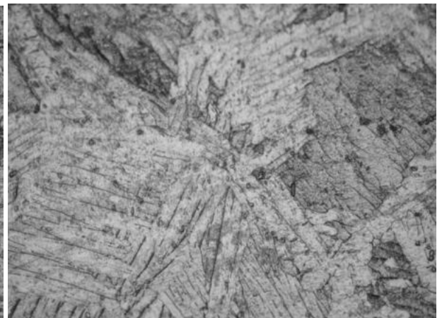
Рисунок 1в - Мікроструктура сплаву ПТ-1М після пресування та охолодження на повітрі (внутрішня поверхня)
