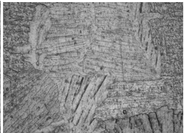
Рисунок 1б - Мікроструктура сплаву ПТ-1М після пресування та охолодження на повітрі (середина стінки)
