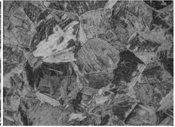
Рисунок 3б - Мікроструктура сплаву Grade 9 після пресування і охолодження на повітрі (середина стінки)
