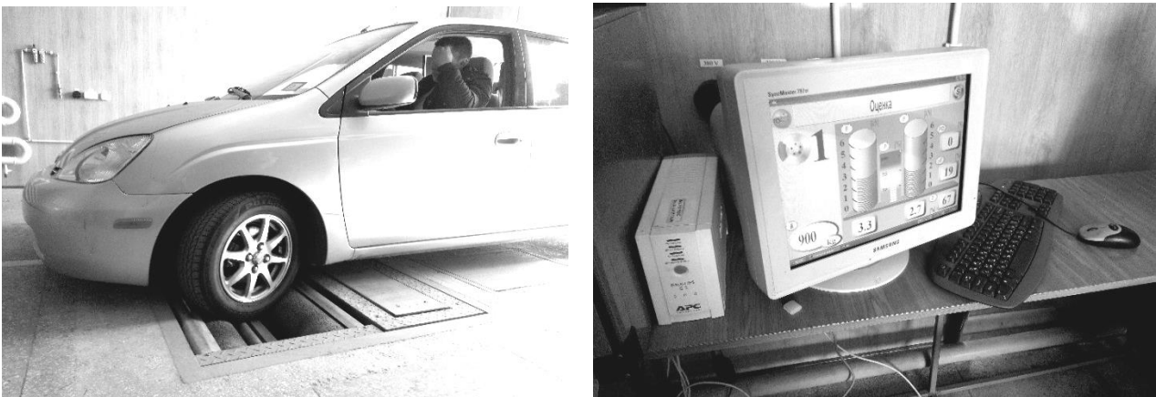
Рисунок 4 – Стенд Bosch по оцінці технічного стану гальма і підвіски автомобілів
