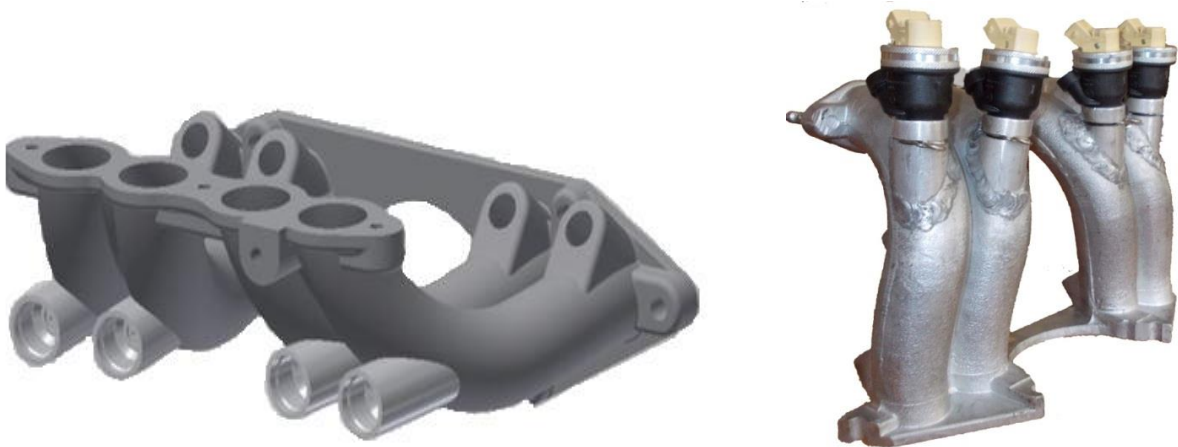
Рисунок 5 – 3D модель модернізованого впускного колектора та його фотографія
