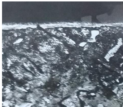
Рисунок 2 – Мікроструктура нітроцементованого шару на сірому чавуні, \times 200
