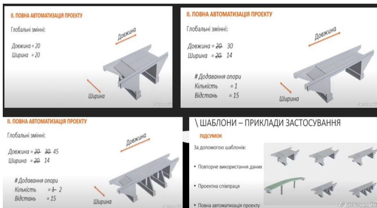
Рисунок 1 – Параметричні зміни моделі (автоматизація проекту) [4]
