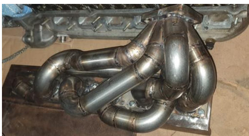
Рисунок 1 - Етапи виготовлення випускного колектора
