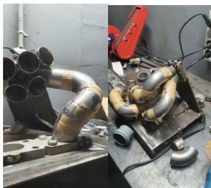
Рисунок 1 - Етапи виготовлення випускного колектора
