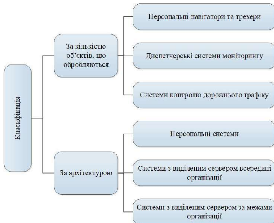
Рисунок 2.4 - Класифікація систем моніторингу мобільних об'єктів
