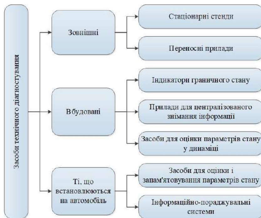
Рисунок 2.6 - Класифікація засобів технічного діагностування автомобіля
