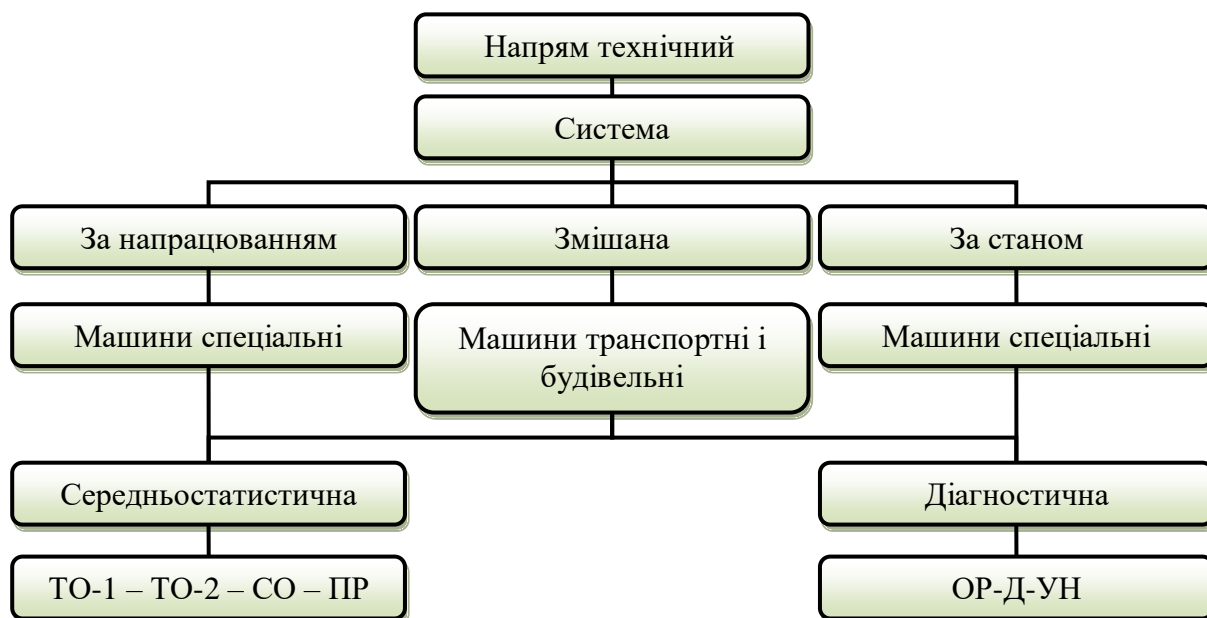
Рисунок 1.2 - Схема організації ТО і Р транспортних машин
