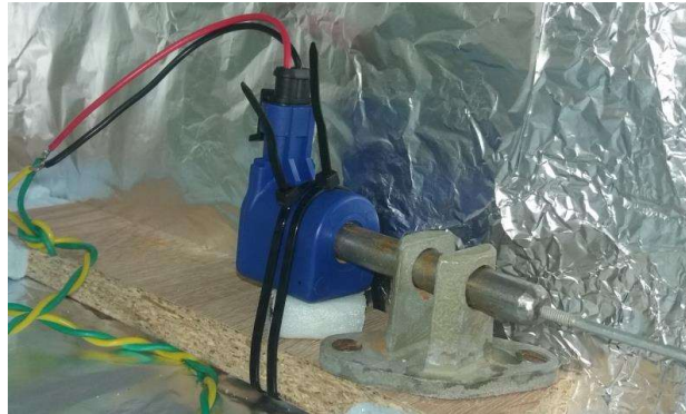
Рисунок 3 – Розміщення макетного зразка датчика положення педалі зчеплення всередині термокамери
