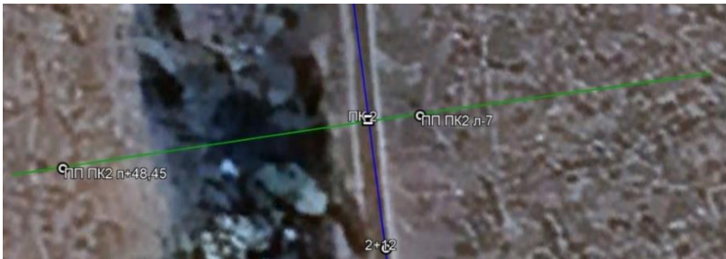
Рисунок 6 – Розбивка траси на точки перелому
