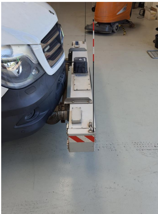
Рисунок 2 – Система фірми Dynatest для вимірювання рівності і шорсткості дорожніх покриттів
