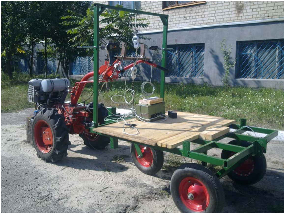
Рис. 3. Общий вид установки для тяговых испытаний мотоагрегатов
