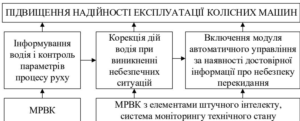
Рисунок 1 – Структурна схема забезпечення надійності експлуатації колісної машини
