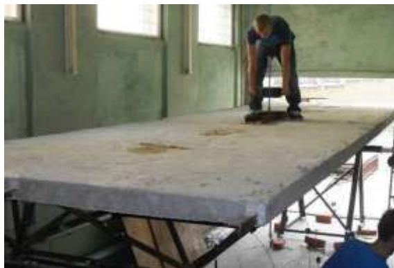
Рисунок 9 – Експериментальне визначення частот власних коливань
