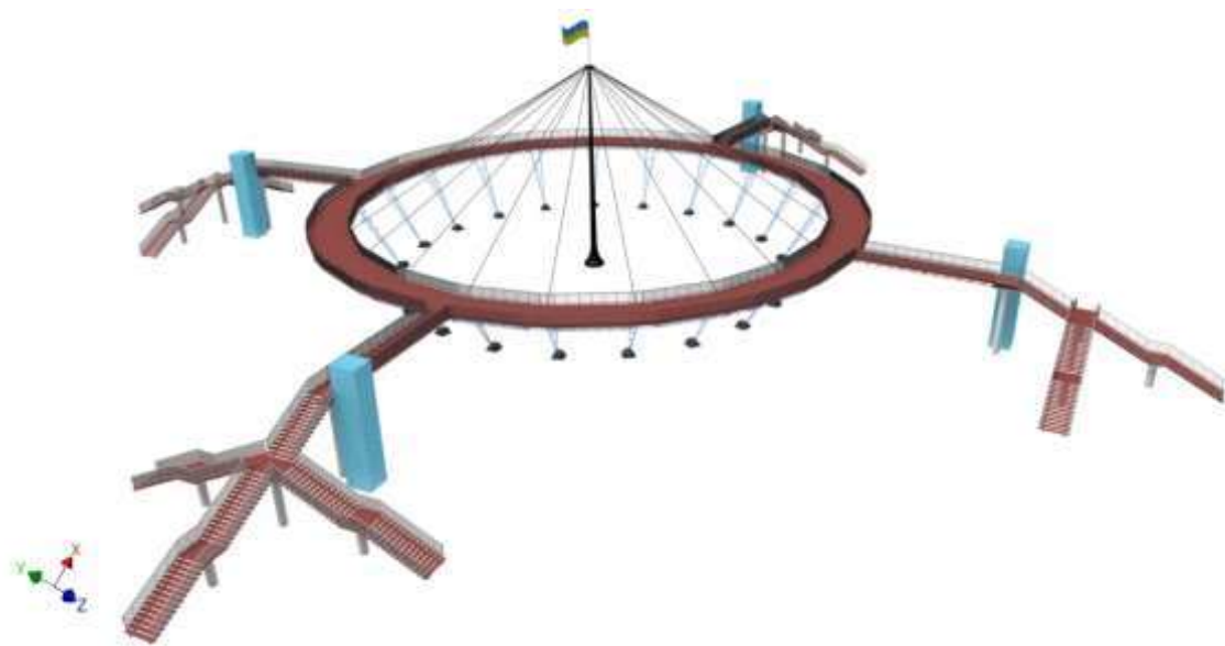
Рисунок - Конструкція пішохідного мосту з круговим рухом зі сходами
