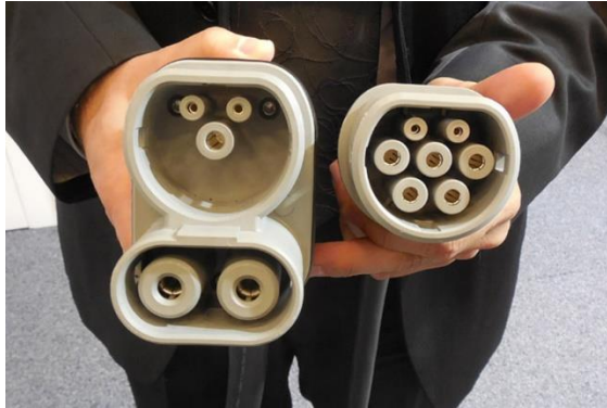
Рисунок 6 – Штекери SAE Combo2 зарядки (зліва, зарядка в режимі Mode 4) і Mennekes (праворуч, Mode 1,2,3), основні стандарти для Європи
