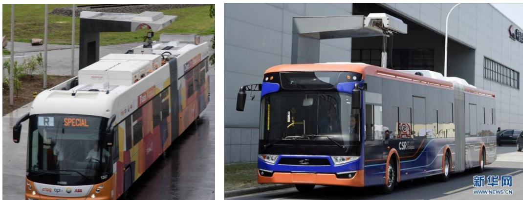
Рисунок 2.6 – Електробус з суперконденсаторним накопичувачем енергії Zhuzhou Electric Locomotive
