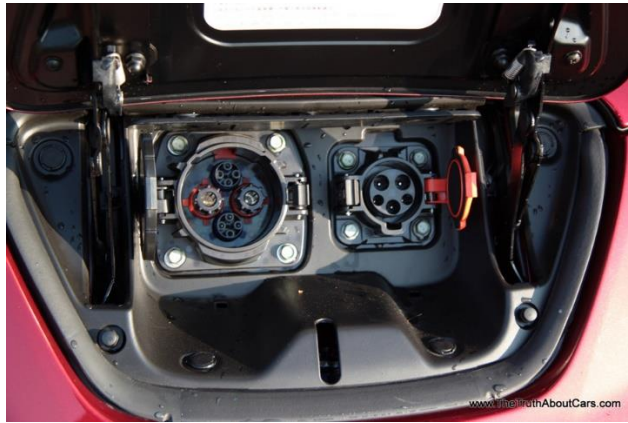
Рисунок 4 – Порти Nissan Leaf. Зліва CHAdeMO (Level 3) до 50 кВт. Праворуч – стандартний для США SAE J1772 (Level 1/2).
