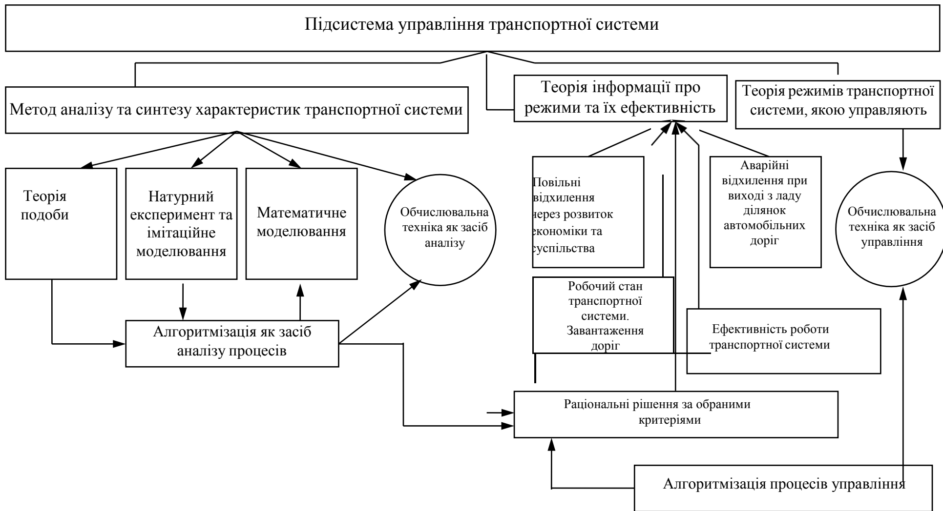
Рисунок 1 – Структурна схема підсистеми управління транспортної системи
