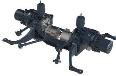
Рисунок 4 Портальний міст американської фірми "AxleTech" із двома ТЕД
