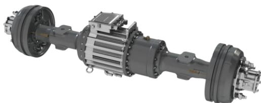
Рисунок 7 Привідний електричний міст американської фірми "Dana Inc."
