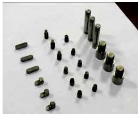
Рис. 8. Детали погружного модуля «ТВЕРЦА–ПМ–Т», подвергаемые упрочнению по технологии ГПА
