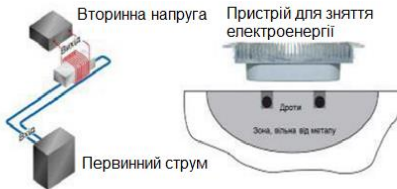
Рисунок 1 – Принцип дії та конструкція пристрою бездротової передачі електроенергії фірми VANLE
