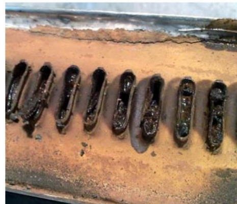
Рис. 4. Корозійний шар на внутрішній поверхні блока двигуна та у внутрішній порожнині радіатора із засміченням каналів [2].
