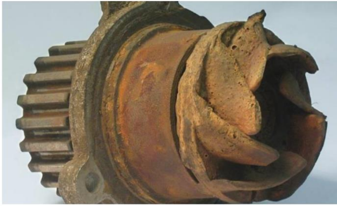
Рис. 3. Кавітаційна ерозія та забруднення лопатей крильчатки рідинного насоса двигуна [2]
