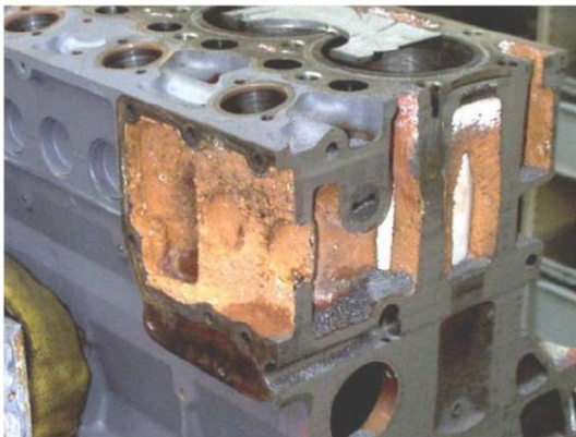
Рис. 4. Корозійний шар на внутрішній поверхні блока двигуна та у внутрішній порожнині радіатора із засміченням каналів [2].
