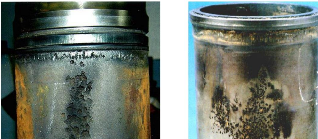
Рис. 2. Кавітаційна ерозія гільзи двигуна [1].
