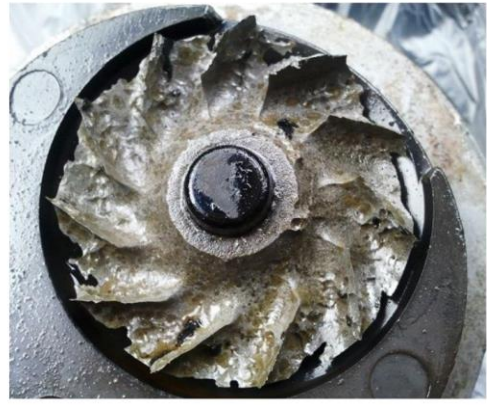
Рис. 3. Кавітаційна ерозія та забруднення лопатей крильчатки рідинного насоса двигуна [2]
