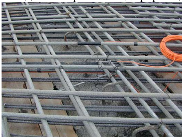
Рисунок 2 – Оптоволоконні датчики: а – вбудовані; б – на бетонних балках
