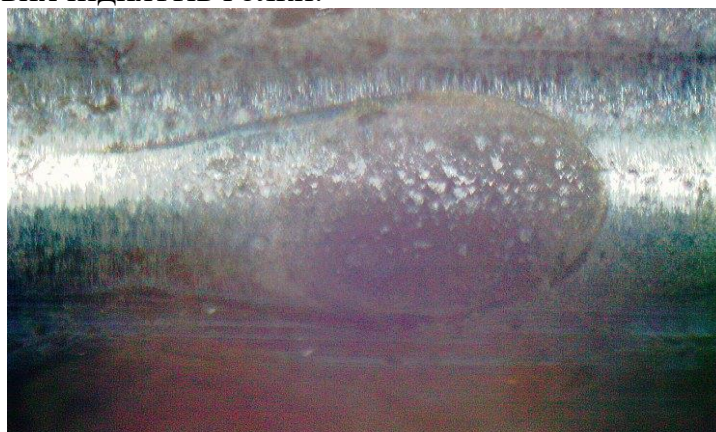
Рисунок 1 – Осередок корозії в зоні контакту спряжених поверхонь форсунки
