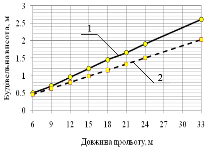
Рисунок 1 - Зв'язок між довжиною і висотою конструкції: 1 - без урахування вкладишів; 2 - з урахуванням вкладишів
