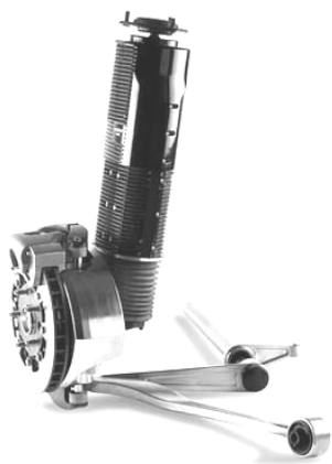
Рис. 7. Подвеска с линейными электродвигателями
