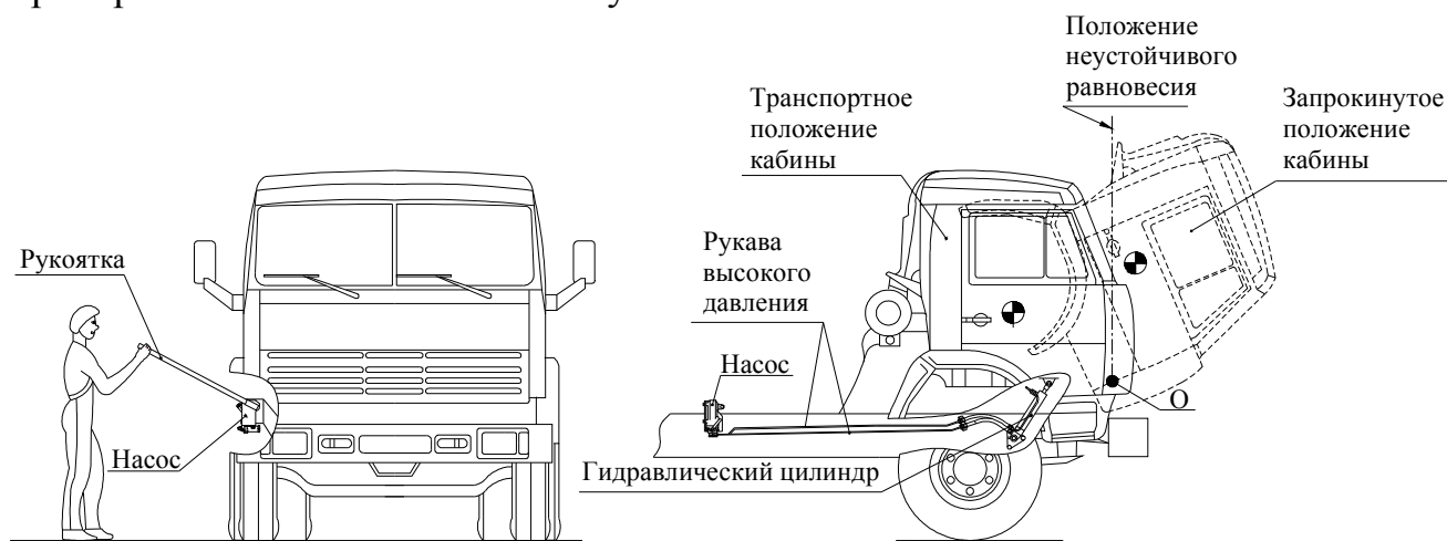
Рис. 1. Общая схема расположения элементов гидравлического механизма опрокидывания кабины и рабочее место оператора
