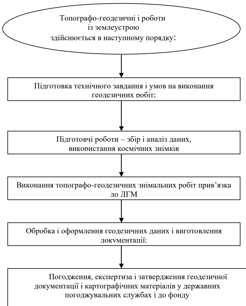
Рис. 1 – Структурно-логічна схема виконання робіт з геодезії, землеустрою
