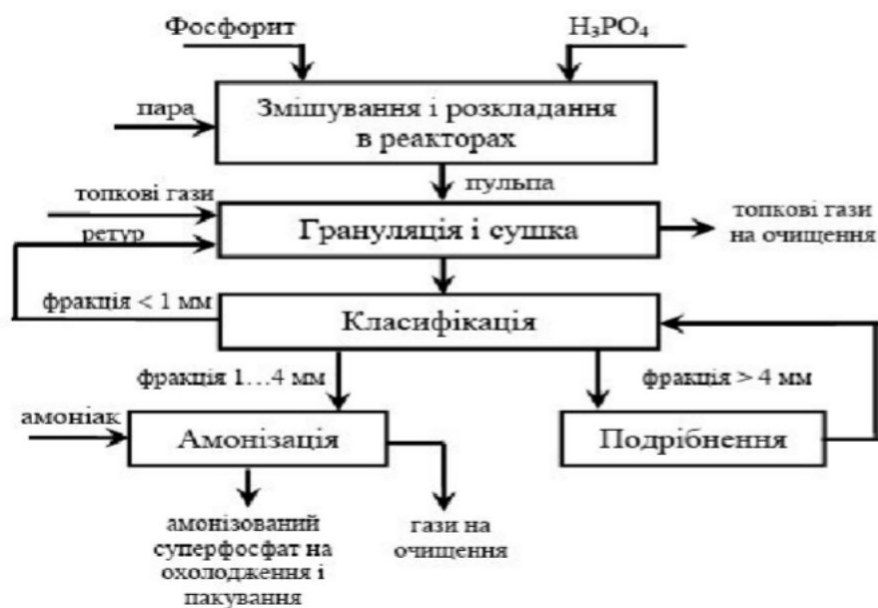
Рисунок. 7.2 – Схема одержання подвійного суперфосфату
