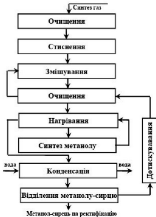
Рисунок. 8.1 – Функціональна схема синтезу метанолу
