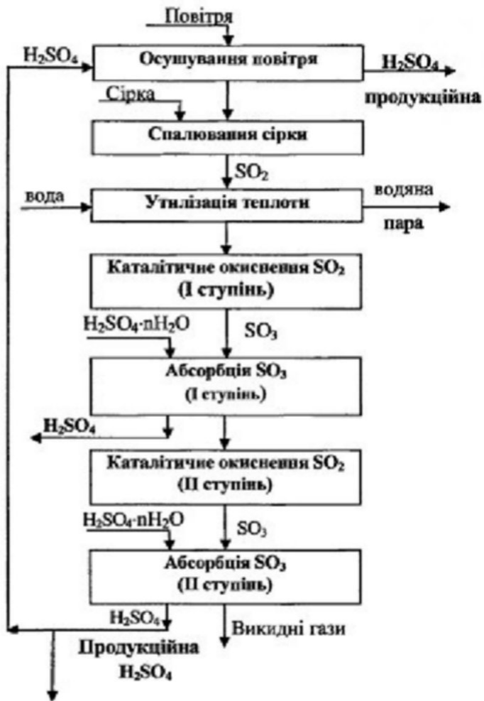
Рисунок 5.2. – Функціональна схема виробництва сульфатної кислоти методом подвійного контактування і подвійної абсорбції
