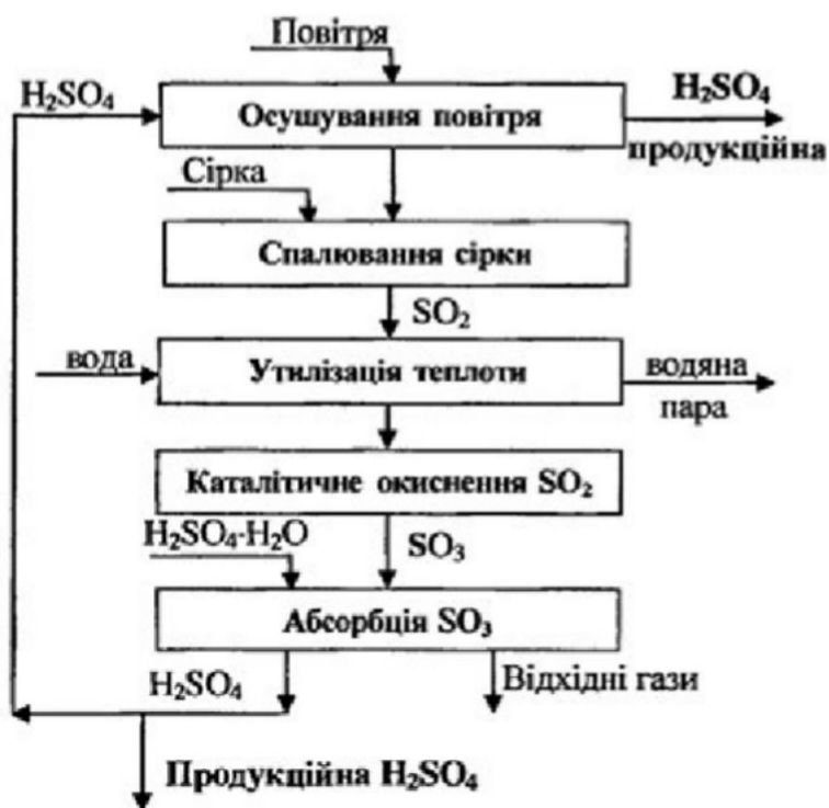
Рисунок 5.1. – Функціональна схема виробництва сульфатної кислоти методом одинарного контактування
