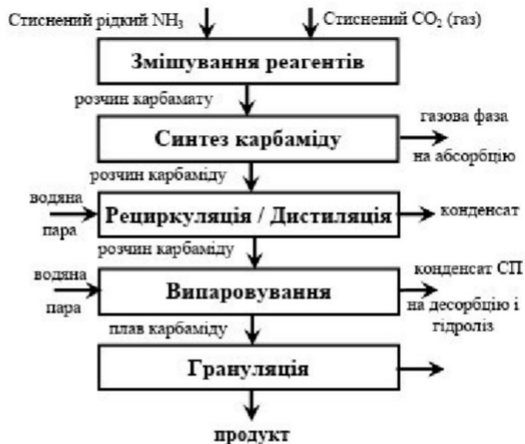
Рисунок. 7.7 – Функціональна схема виробництва карбаміду
