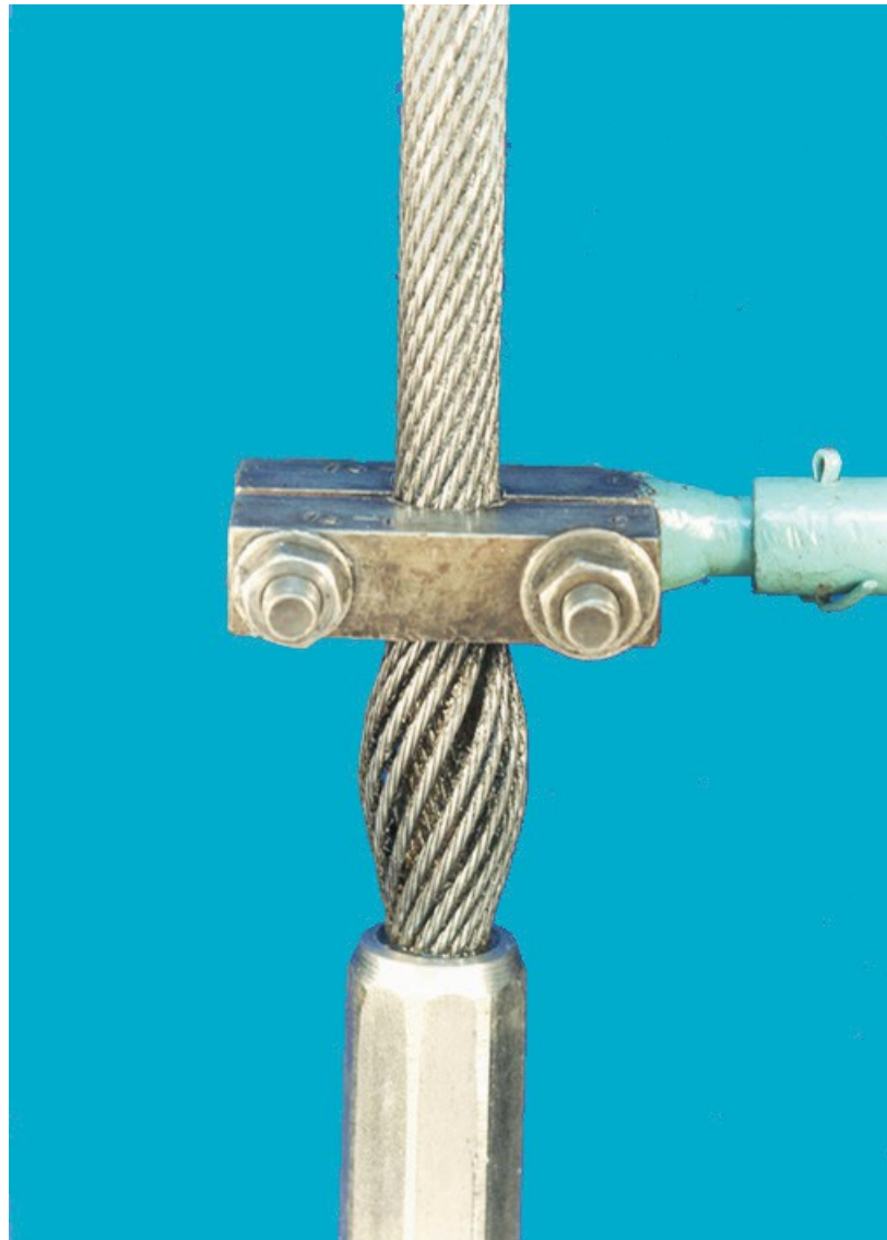
Рис.16.3 - Положення затискача, закріпленого на канаті.
