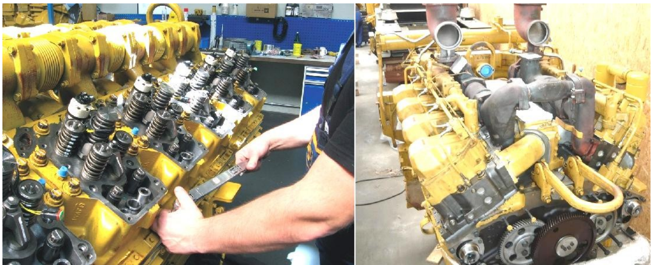
Рис. 14.4 – Ремонт двигуна екскаватора Caterpillar 6090 FS
