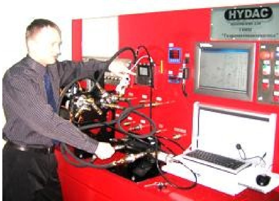
Рис. 14.10 – Перевірка гідроапаратури на сучасному стенді HYDAC
