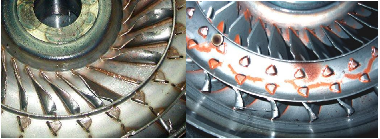
Рис. 14.9 - Зношення робочих поверхонь лопаток гідротрансформатора
