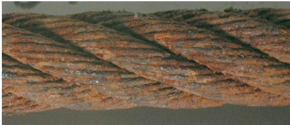
Рис.14.16 - Поверхня дроту значно постраждала від окислення — Рейтинг: 60 % на шляху до бракування
