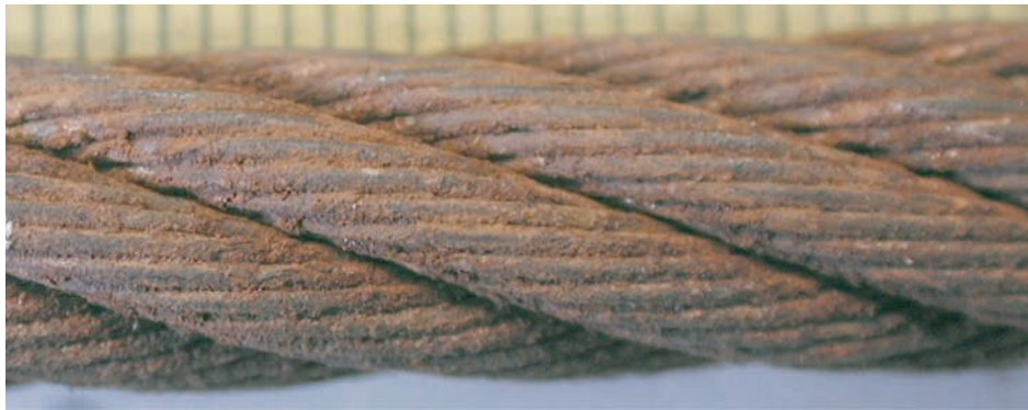
Рис.14.15 - Дроти шорсткі на дотик, загальне окислення поверхні. Рейтинг: 20 % на шляху до бракування
