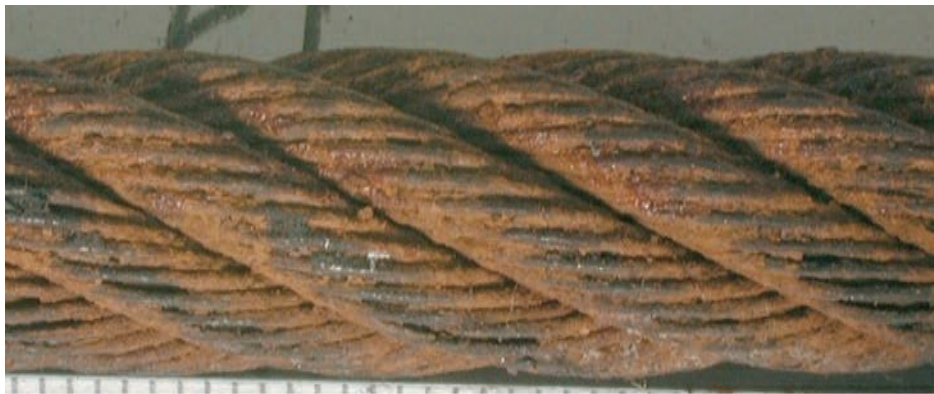
Рис.14.17 - Поверхня сильно пошкоджена, дроти досить провислі, проміжки між дротами. Дефекти критичні, канат негайно вилучається з експлуатації.
