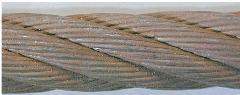
Рис.14.14 - Початок поверхневого окислення, можна протерти. Рейтинг: 0 % на шляху до бракування
