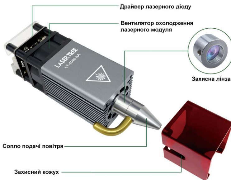
Рис. 3. Лазерний модуль LT-40W-AA з оптичною потужністю 5Вт
