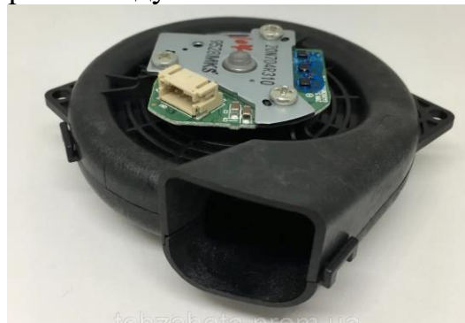
Рис. 4. Спеціалізований компресор для примусової циркуляції повітря
