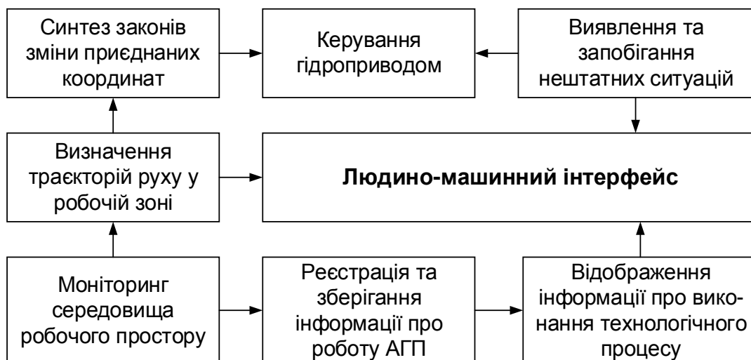
Рис. 1. Функціональна схема АСК АГП
