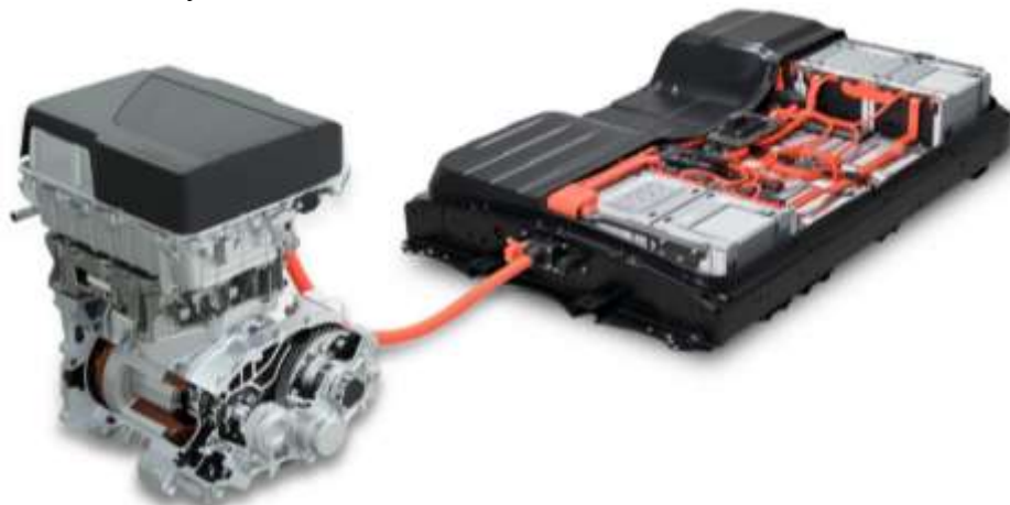
Трансмісія Nissan Leaf e+ 2019 і акумуляторна батарея
