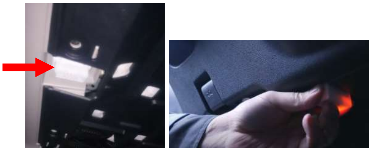
Рис. 2 Місце встановлення адаптера OBD II
