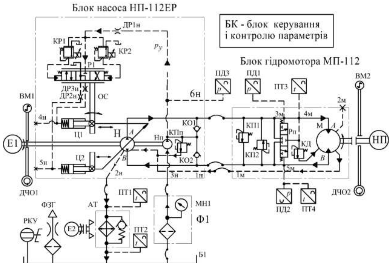
Рис. 2.17. Гідравлічна принципова схема об'ємної гідропередачі ГСТ 112x112 виробництва ВАТ «Гідросила» з електрогідравлічним пропорційним керуванням робочого об'єму насоса
