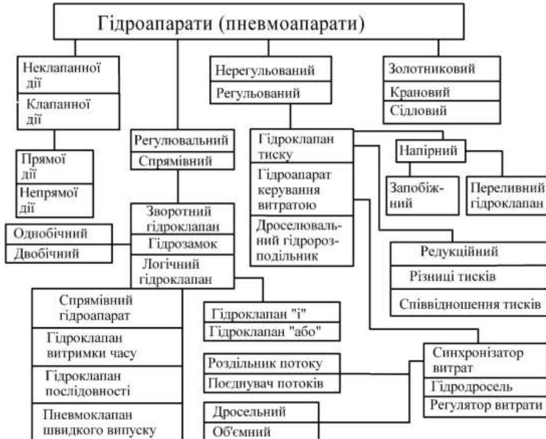
Рис. 4.1. Класифікація гідроапаратури (пневмоапаратури)
