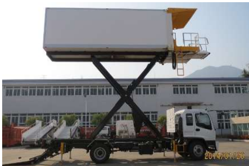
Рис. 1.8. Кейтеринговий підйомник-автоліфт моделі PG-KP3.2 виробництва Prodis-Group-Україна
