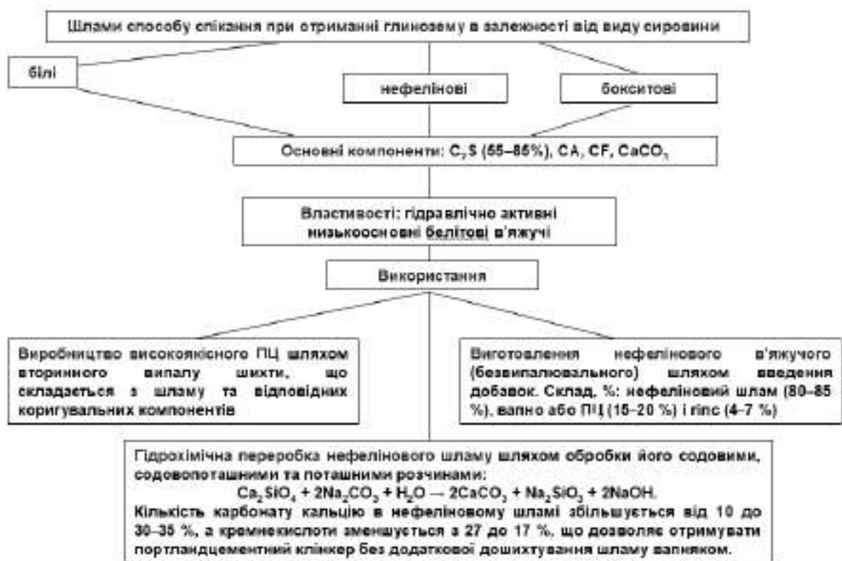
Рис. 4.11. Різновиди шлаків, одержуваних під час спікання, залежно від складу сировини
