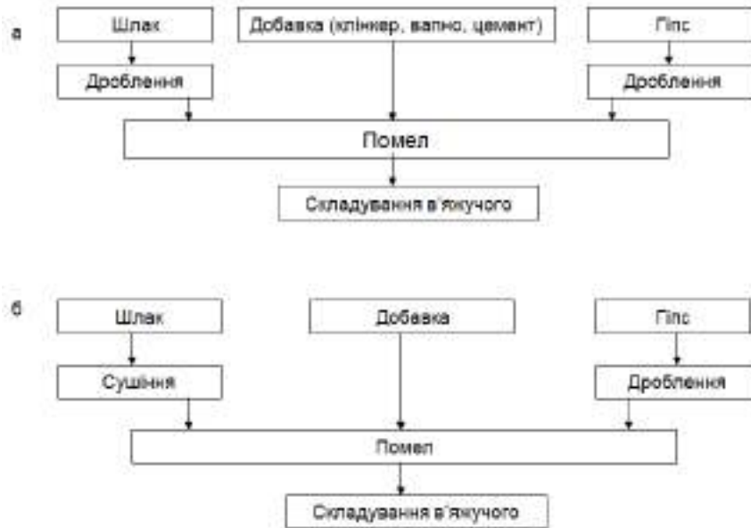
Рис. 11.17. Технологічні схеми виробництва змішаних шлакових в'язучих речовин: а – I схема (сировина – відвальні шлаки); б – II схема (сировина – гранульовані шлаки)
