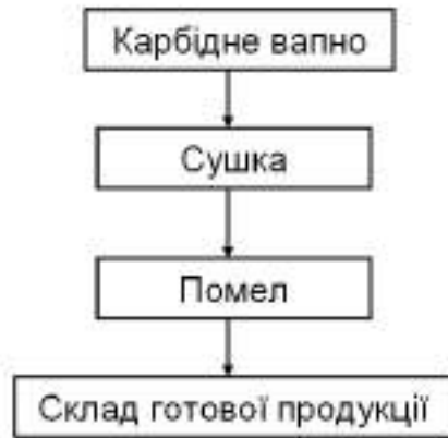
Рис. 3.1. Технологічна схема виробництва маломagneзiального вапна
