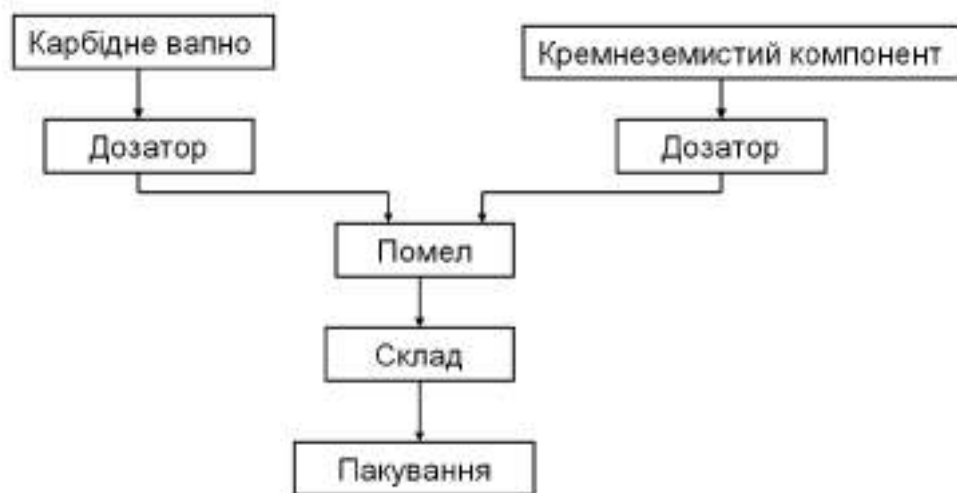
Рис. 3.3. Технологічна схема виготовлення вапняно-кремнеземистих в'язучих автоклавного твердіння
