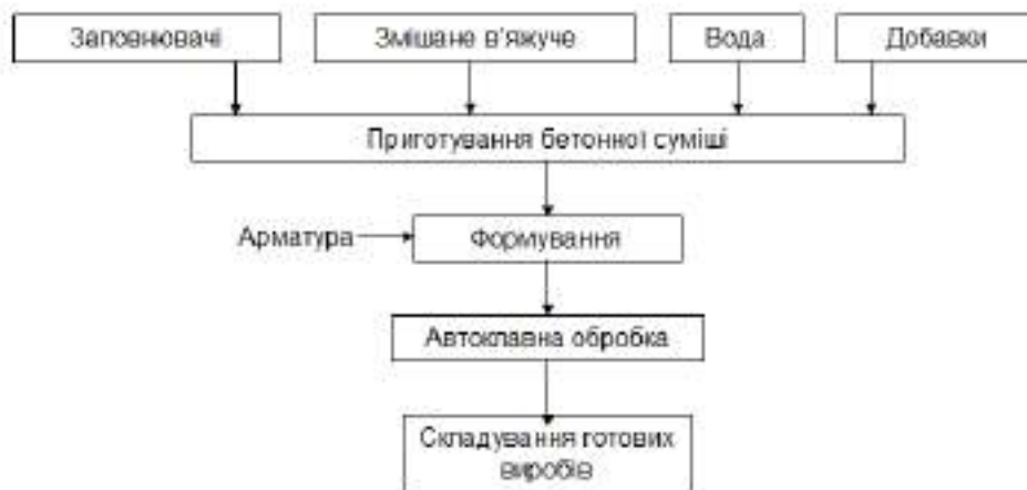
Рис. 11.13. Принципова технологічна схема виготовлення виробів на основі змішаного в'язучого
