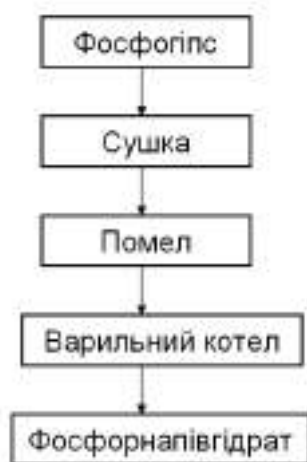
Рис. 2.1. Схема виробництва \beta -модифікації \text{CaSO}_4 \cdot 0,5\text{H}_2\text{O} у варильних котлах
