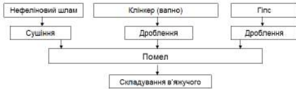
Рис. 11.19. Технологічна схема отримання нефелінового в'язучого
