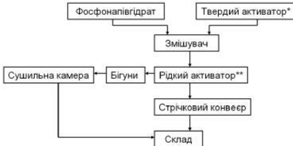
Рис. 2.3. Схема двостадійної обробки \text{CaSO}_4 \cdot 0,5\text{H}_2\text{O} , де: * твердий активатор – портландцемент, нефеліновий шлам або інший силікатовмісний компонент; **рідкий активатор – водний розчин сульфатної кислоти, кремнефторістоводневої кислоти або іншої сильної кислоти
