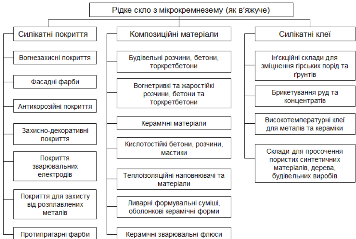
Рис. 11.9. Застосування рідкого скла як самостійного повітряного в'язучого у складі композиційних матеріалів, силікатних клеїв та силікатних покриттів
