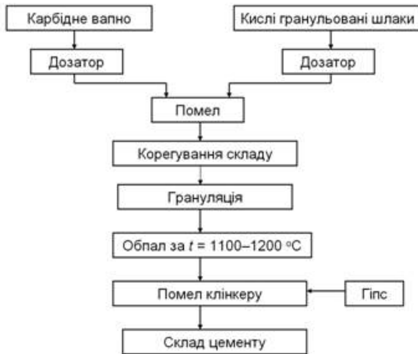
Рис. 3.4. Технологічна схема виробництва белитового цементу
