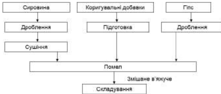
Рис. 11.12. Принципова технологічна схема отримання змішаної в'язучої речовини
