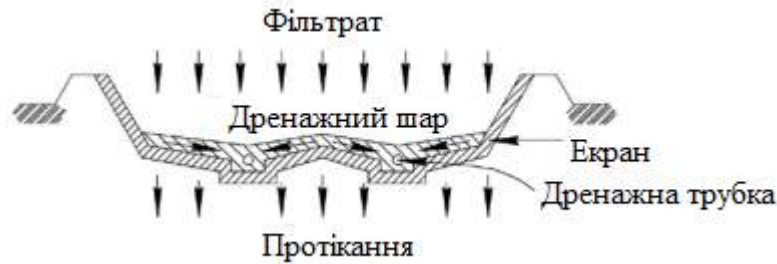
Рис. 5.1. Система протифільтраційного захисту майданчика складування шлакових відходів
