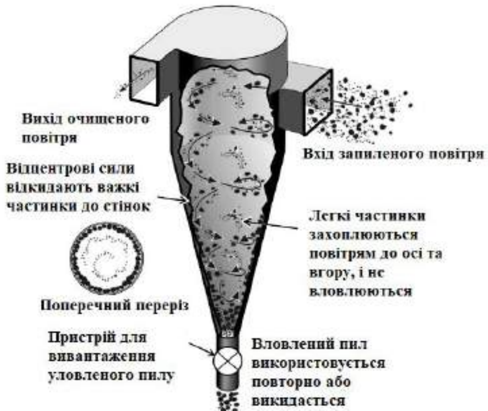
Рис. 6.4. Влаштування циклону
