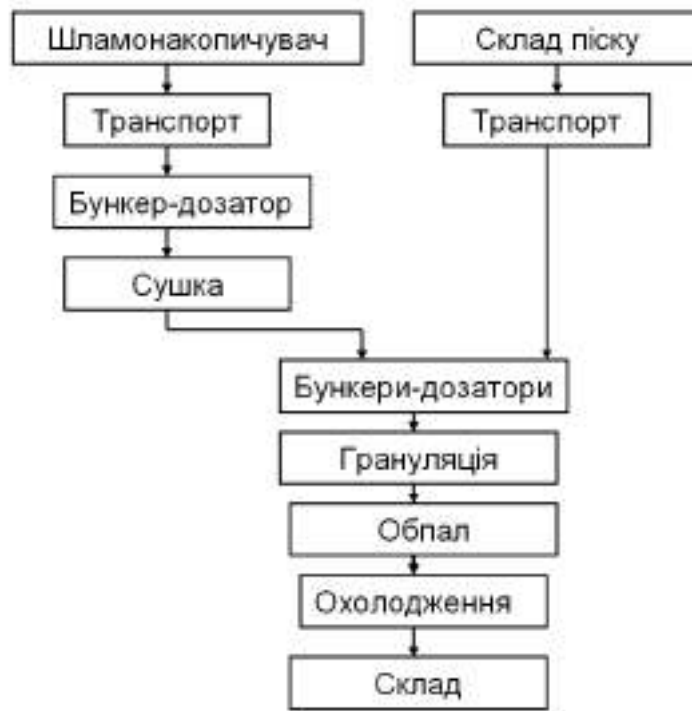
Рис. 3.5. Технологічна схема виробництва вапняно-білітового в'язучого на базі відходів содового виробництва
