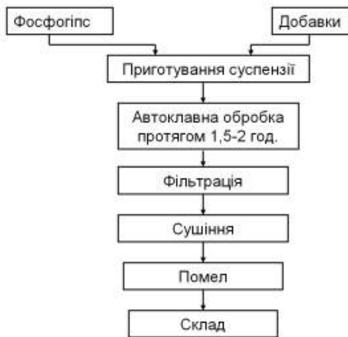
Рис. 2.5. Схема обробки сировини в рідкому середовищі з додаванням ПАР з подальшою обробкою в автоклавах
