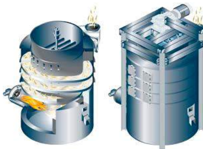
Рис. 2.2. Влаштування варильних котлов
