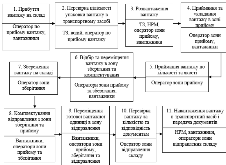
Рисунок 2. Схема встановленої послідовної взаємодії в складській системі виробничого підприємства з урахуванням ресурсів, що задіяні
