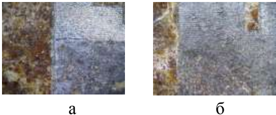
Рис. 3. Вигляд поверхні сталевго зразка після очищення за різних умов фокусування
