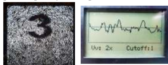
Рис. 2. Вигляд (а) та профілограма (б) поверхні сталевго зразка після очищення від іржі у два проходи
