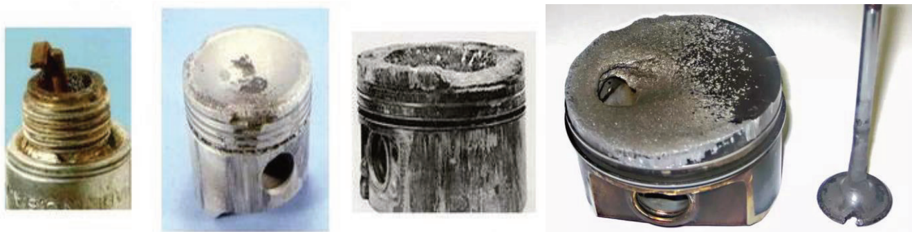
Рисунок 2.11 – Деталі двигуна зруйновані детонацією
