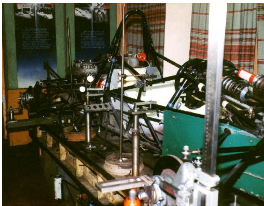
Рисунок. 3.11. Испытание рамы на изгиб с кручением.
