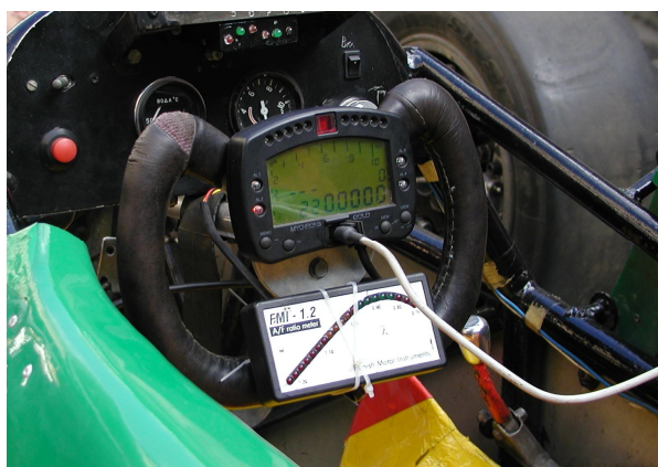
Рисунок. 1.11. Размещение на автомобиле “Эстония-25-ХАДИ” программно аппаратного комплекса «AIM My-Chron 3 Gold + Data Logger EVO3 kart systems».
