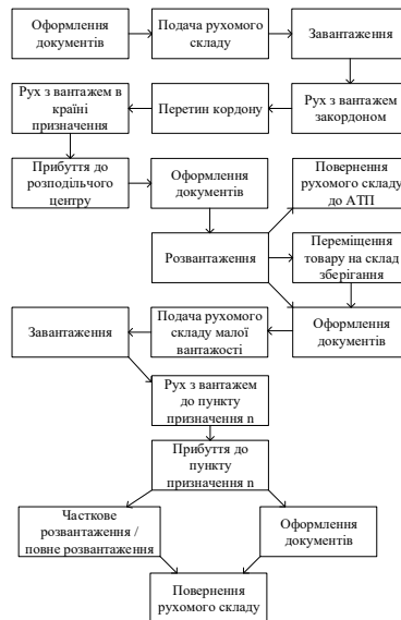
Рисунок 1.2 – Схема послідовності елементів транспортного процесу при доставці вантажу за допомогою дворівневої моноцентричної розподільчої системи
