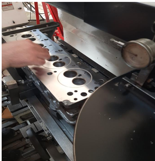
Рисунок 3 – Процес механічної обробки вогневої поверхні головки блоку циліндрів двигуна 4ЧН 8,8/8,2
