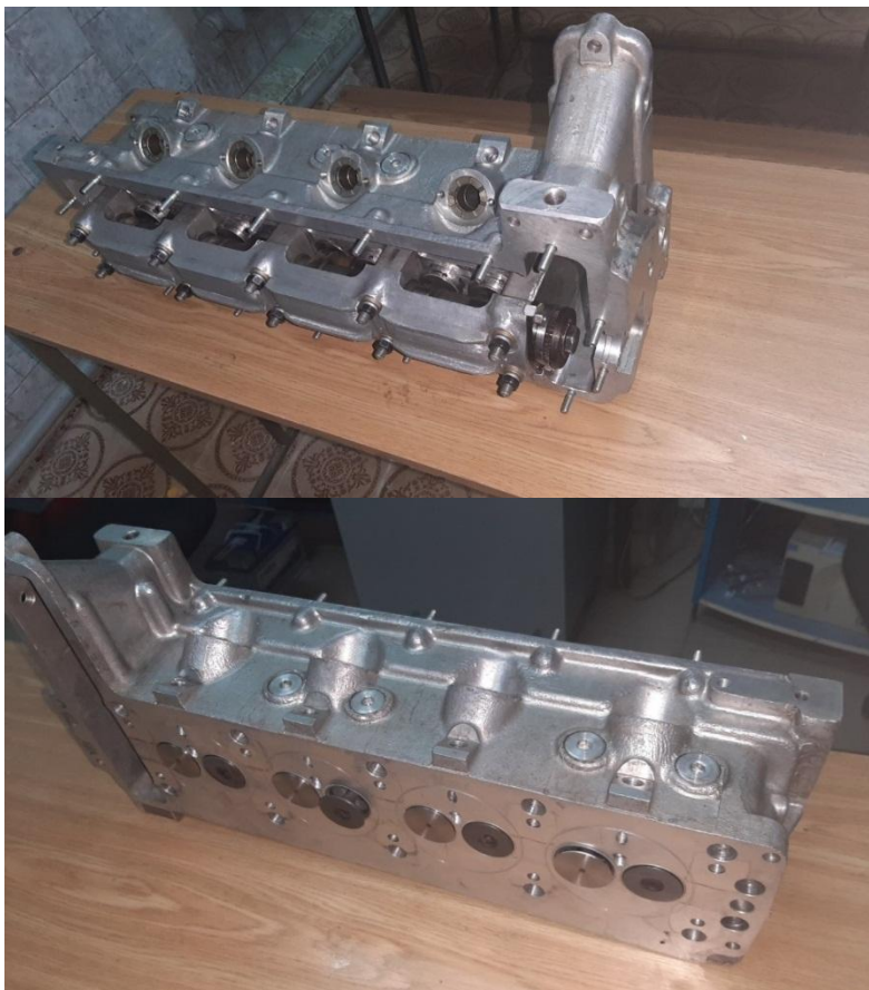
Рисунок 4 – Фотографії головки блоку циліндрів двигуна 4ЧН 8,8/8,2 у зборі
