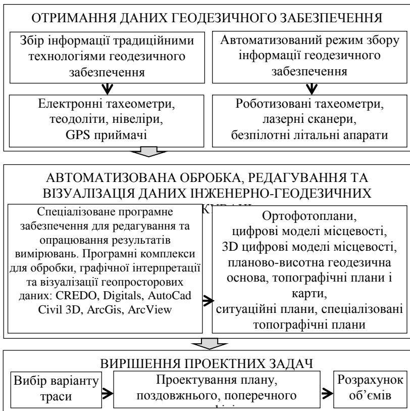
Рис. 1 – Геодезичне забезпечення проєктування автомобільних доріг
