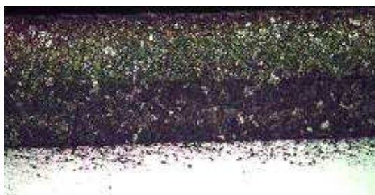
Рис. 5. Микроструктура азотированного слоя, имеющая несколько фаз, \times 600
