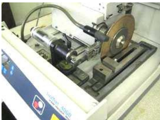
Рис. 2. Отрезной прецизионный (высокоточный) станок
