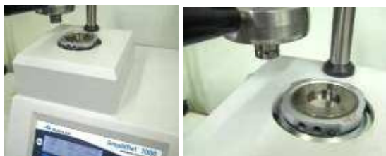
Рис. 3. Станок для горячей запрессовки
