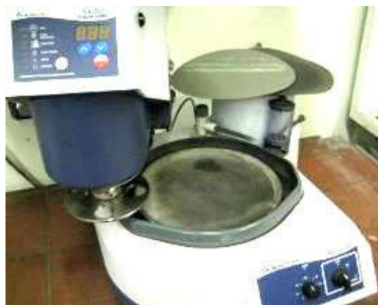
Рис. 4. Шлифовально-полировальный станок Vector/Beta
