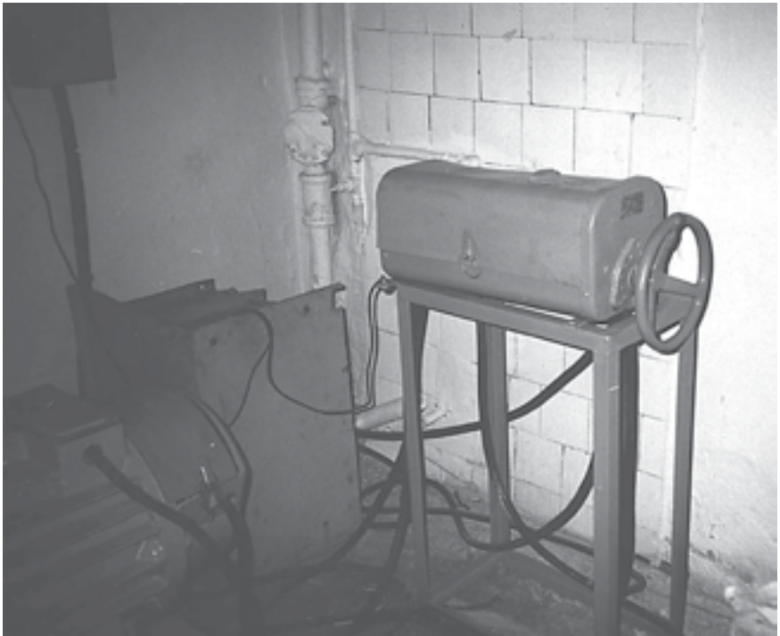
Рис. 11.21. Пульт управління інерційним стендом
