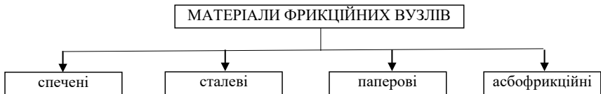
Рис. 10.8. Основні матеріали фрикційних вузлів
