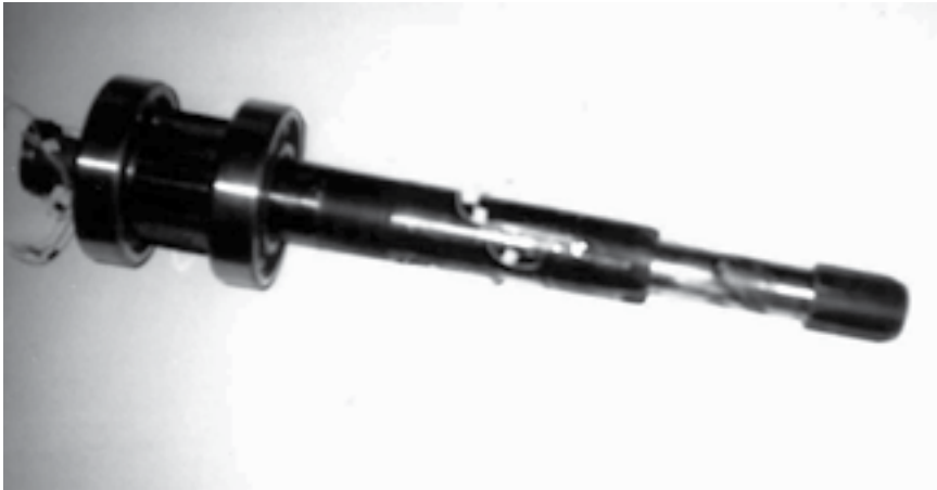
Рис. 11.22. Вал гальмівного механізму з тензодатчиками
