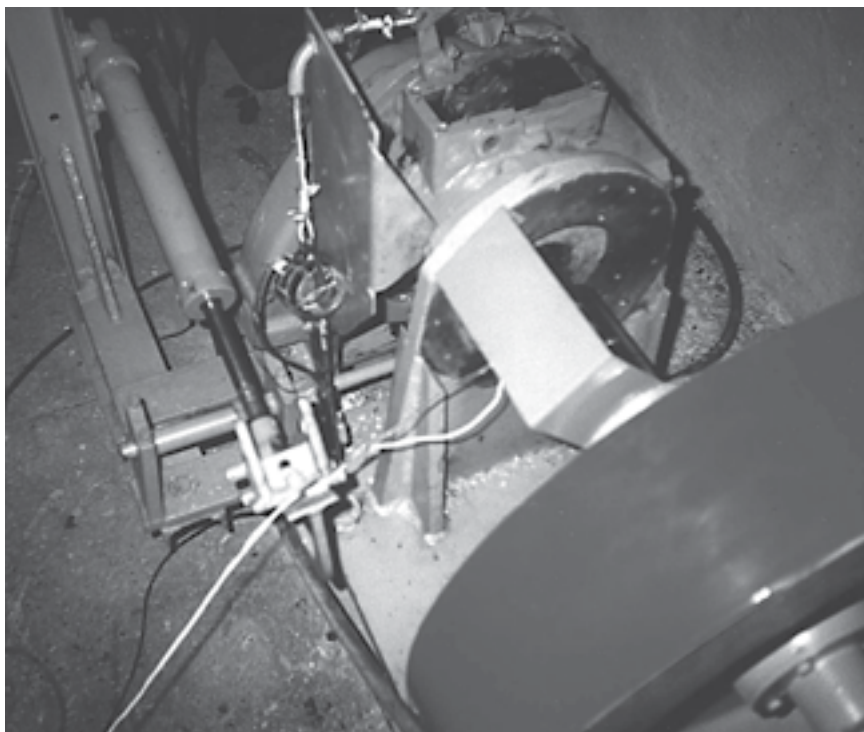
Рис. 11.26. Пристрій для реєстрації зусилля в механічному приводі гальмівного механізму: 1 – пневмоциліндр приводу гальмівного механізму; 2 – тензозвено з наклеєними тензодатчиками
