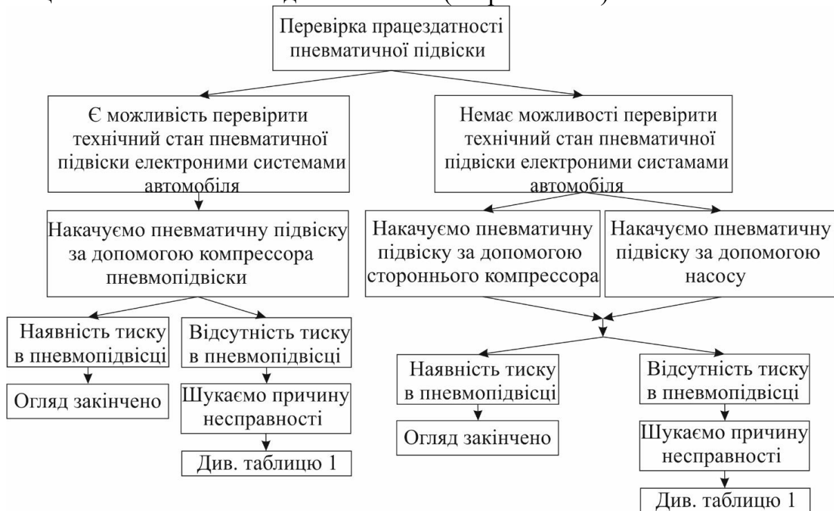
Зображення 1. Алгоритм пошуку несправностей пневматичної системи ходової частини.
